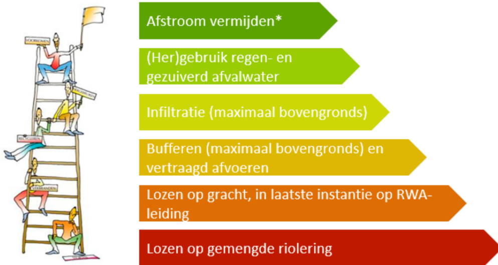
Figuur 13: Ladder van Lansink (*Afstroom vermijden kan door verharding te beperken, drainage te verminderen, ...). (Coördinatiecommissie Integraal Waterbeleid, 2021)
