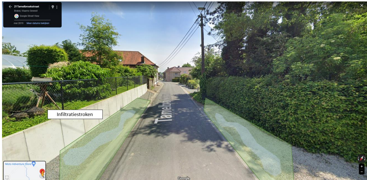
Figuur 26: Voorbeeld afkoppeling verharding openbaar domein t.h.v. Tamelbroekstraat: weinig ruimte, maar wel nog mogelijkheden tot vergroening en verlaging van bermen waar hemelwater gedeeltelijk kan infiltreren. Een verder afwaartse collectieve infiltratie/bufferzone zal hier mogelijk ook nodig zijn.
