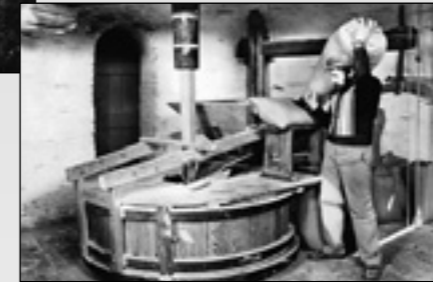
Een maalstoel zoals er één in de Verrebeekmolen aan het werk is.
